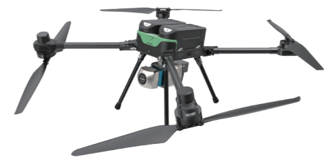
搭载南方SF1200四旋翼无人机 (平飞续航长达60分钟以上)
